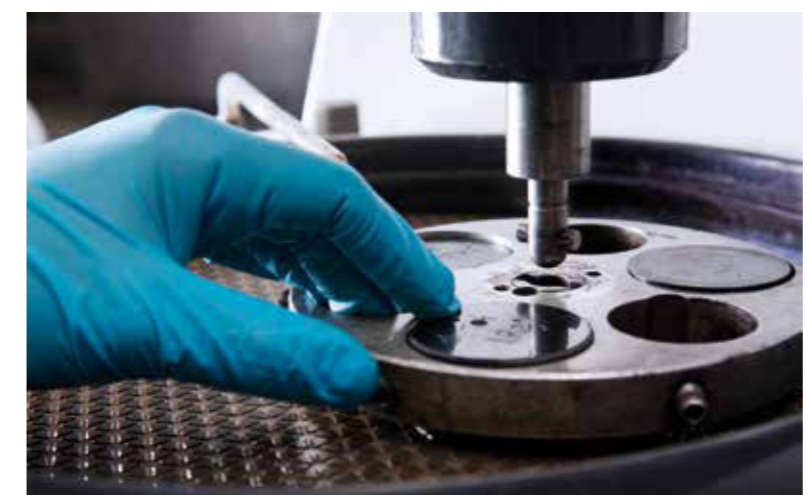
In alto: fasi di preparazione di campioni metallografici A destra: cella elettrolitica per prove di tenso-corrosione in ambiente H 2 S
