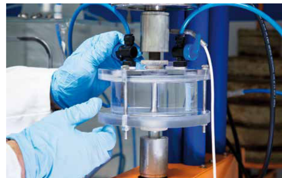
In alto: fasi di preparazione di campioni metallografici A destra: cella elettrolitica per prove di tenso-corrosione in ambiente H 2 S
